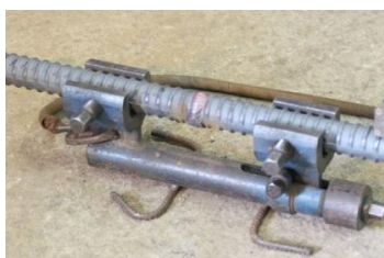
エンクローズ (突合せ) 溶接
