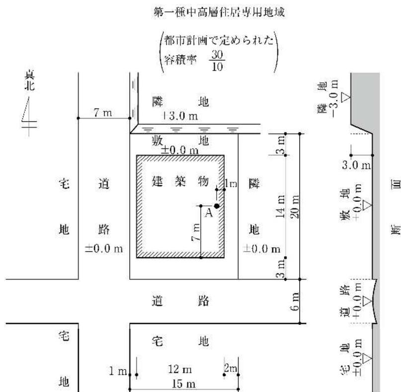
[No. 18] 図のような敷地において、建築物を新築する場合、建築基準法上、A点における地盤面からの建築物の高さの最高限度は、次のうちどれか。ただし、敷地は平坦で、隣地との高低差はなく、門、塀等はないものとする。また、図に記載されているものを除き、地域、地区等及び特定行政庁による指定、許可等並びに日影による中高層の建築物の高さの制限及び天空率に関する規定は考慮しないものとする。なお、建築物は全ての部分において、高さの最高限度まで建築されるものとする。 1. 21.25 m 2. 23.25 m 3. 24.25 m 4. 26.25 m
