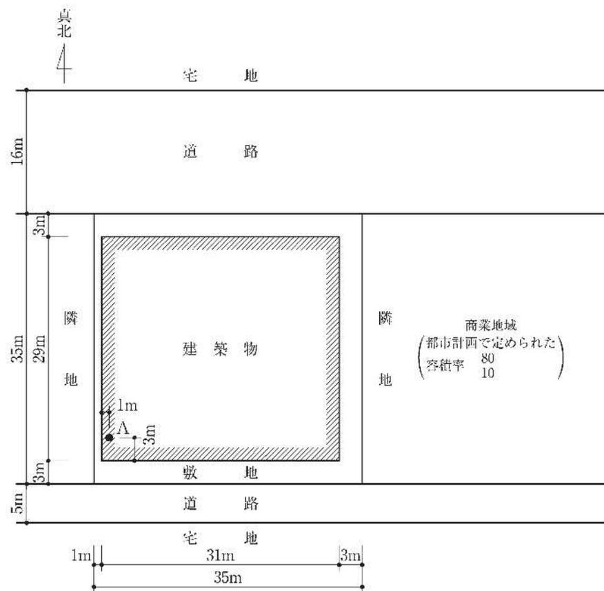
[No. 17] 図のような敷地において、建築物を新築する場合、建築基準法上、A点における地盤面からの建築物の高さの最高限度は、次のうちどれか。ただし、敷地は平坦で、敷地、隣地及び道路の相互間に高低差はなく、門、塀等はないものとする。また、図に記載されているものを除き、地域、地区等及び特定行政庁による指定、許可等並びに日影による中高層の建築物の高さの制限及び天空率に関する規定は考慮しないものとする。なお、建築物は、全ての部分において、高さの最高限度まで建築されるものとする。1. 30.0 m 2. 31.5 m 3. 33.0 m 4. 36.0 m
